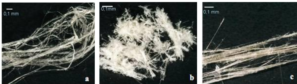
Rysunek 3. Długowłókniasty azbest chryzotylowy praktycznie nie zawierający zanieczyszczeń (a), chryzotylowy azbest krótkowłókniasty zanieczyszczony talkiem (b) i azbest amozytowy (c) [źródło: Bezpieczne postępowanie z azbestem i materiałami zawierającymi azbest].
